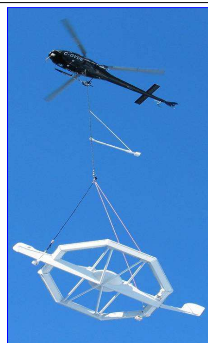
Рисунок 1. Комплекс аэрометодов: электроразведка (АероТЕМ) и высокоточная аэромагниторазведка.
